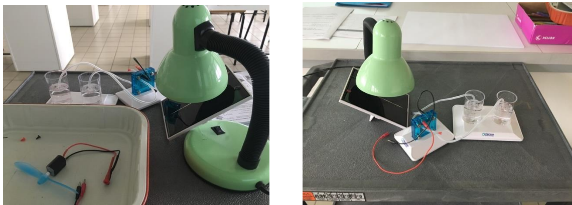
Figure 17 : Montage au bureau de la P.A.C
