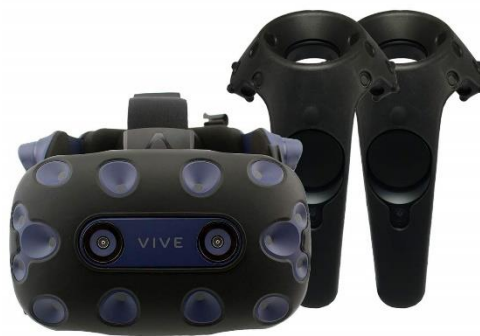
Figure 4 : Casque de RV HTC Vive et ses deux contrôleurs. Source www.vr360inside.com
