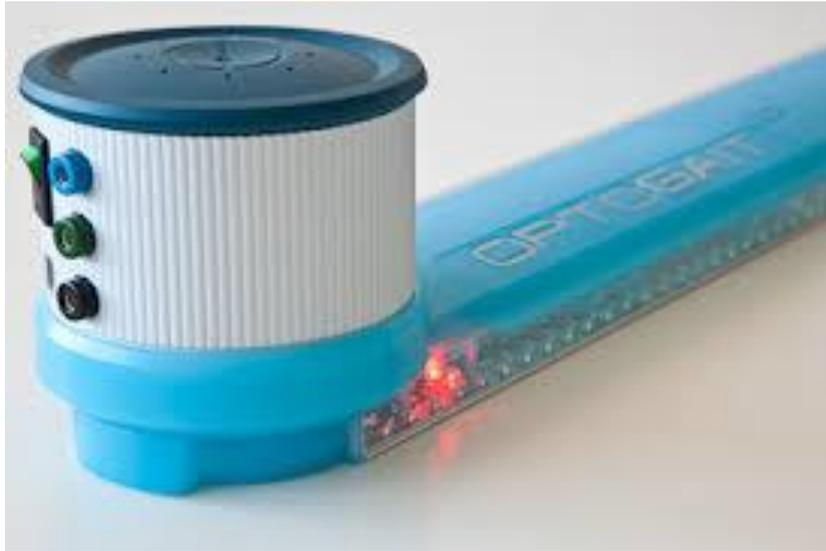
Figure 8 : leds au niveau des barres réceptrices et émettrices
