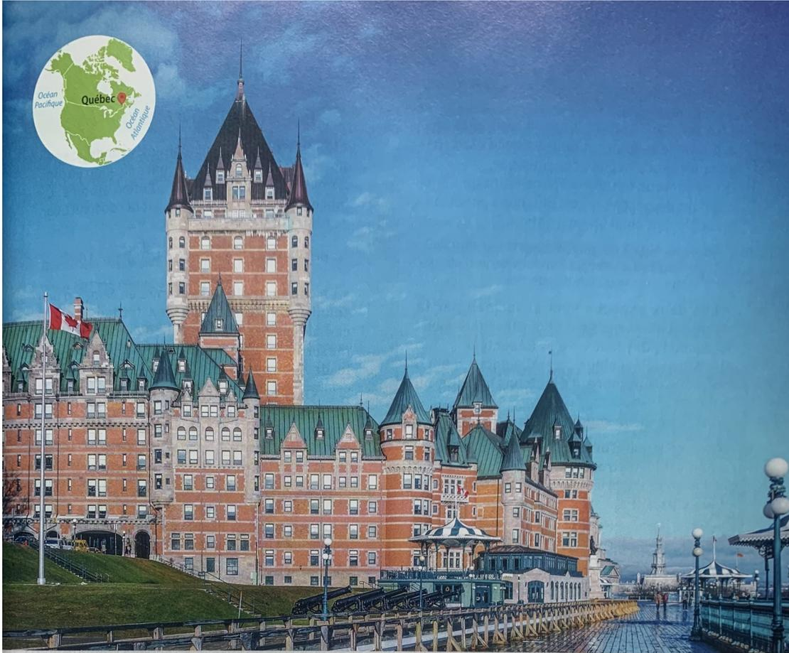
La rénovation de la toiture de la tour centrale du château de Frontenac dans la ville de Québec au Canada met en lumière l'effet de la corrosion : les plaques de cuivre (initialement orangées) s'oxydent spontanément au contact de l'air et de l'eau et deviennent vertes.
