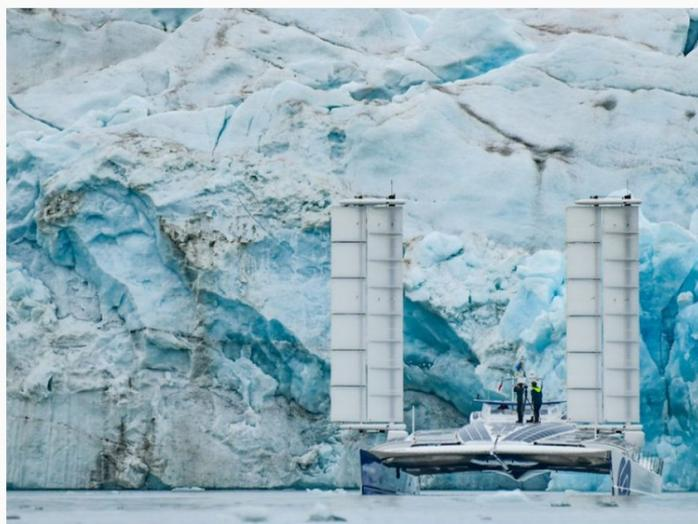
Energy Observer est le premier navire à Hydrogène. Il fait le tour du monde depuis 2017 avec une autonomie énergétique. Il produit du dihydrogène par électrolyse de l'eau de mer. Ce combustible lui permet ensuite de faire fonctionner une pile pour avancer sans rejet de produits carbonés. Quelles électrodes assurent les transferts d'électrons ? Comment ces phénomènes permettent-ils de doser une solution ?
