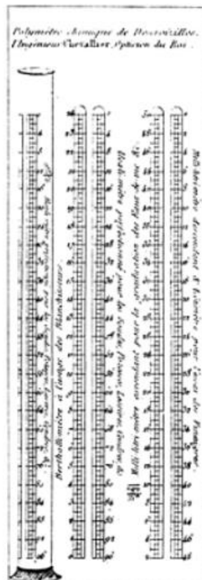
Figure 7 : Polymètre (d'après DESCROIZILLES, 1830)
