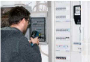
Le thermomètre infrarouge à mémoire PCE-885 s'utilise pour une mesure immédiate de la température superficielle. L'intervalle de température mesurée s'étend de -35 à 1600°C. Temps de réponse : 1s
