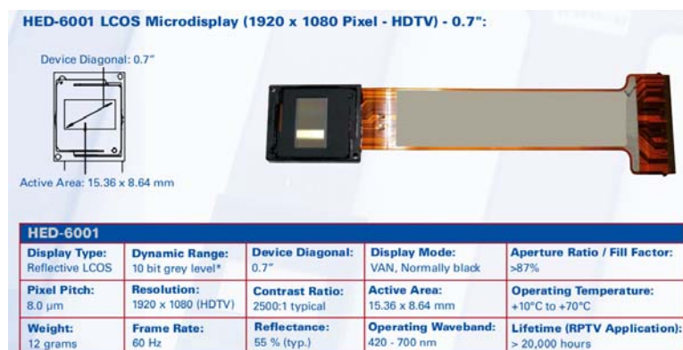
figure 3.5 : Modulateur de lumière de phase pure à cristaux liquides. Extrait des données constructeur disponible sur le site internet de la société Holoeye.
