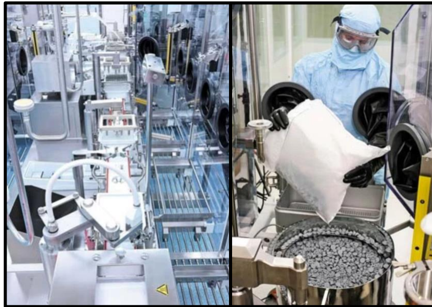
Figure 8 : Exemple d'un RABS et d'une personne en Classe B intervenant en Classe A (25)
