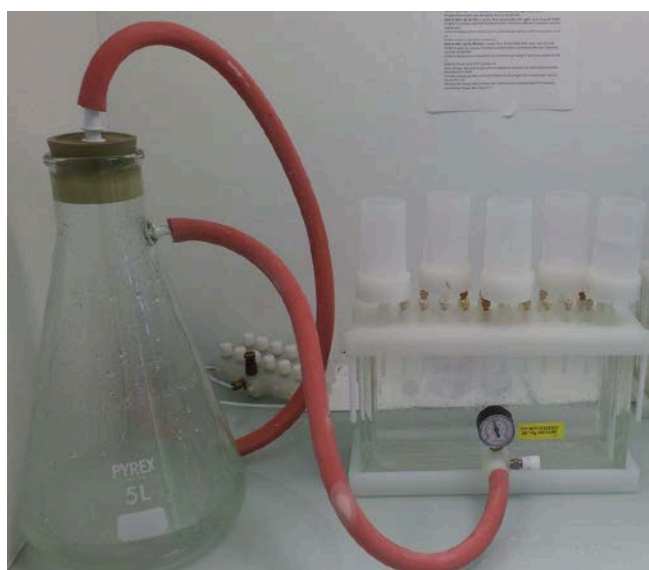
Figure 16 Dopage de disque Empore C 18 maintenus par « Holders » sur un dispositif Visiprep
