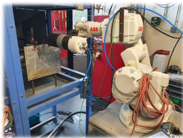
FIGURE 2.6 – Le LPCS SEKOVA dans la cabine de projection de l'IRCER
