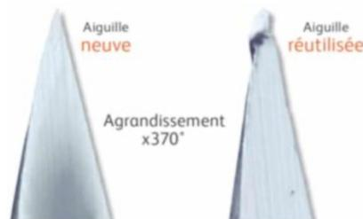
Figure 15 : Aiguille neuve et aiguille réutilisée (115)
