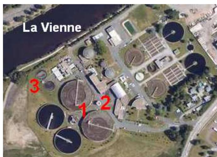
Figure 2-1. La station d'épuration de Limoges (1, Clarificateur ; 2, Recirculation des boues secondaires ; 3, Digesteurs) (d'après une image satellite google map)
