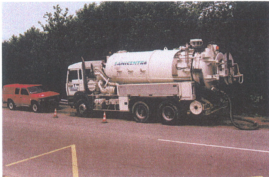
Figure 23 : collection finale des polluants liquides par un camion-pompe.
