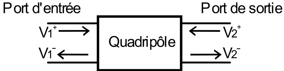
Figure. A 1 Représentation des paramètres S dans un quadripôle
